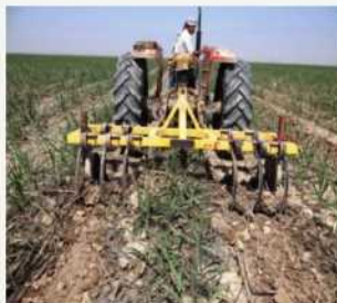
استفاده از کولتیواتور پنجه غازی برای مبارزه با علف های هرز
