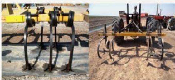
شکل ۶ - نمونه‌هایی از کولتیواتورهای سه و پنج تیغه‌ای
